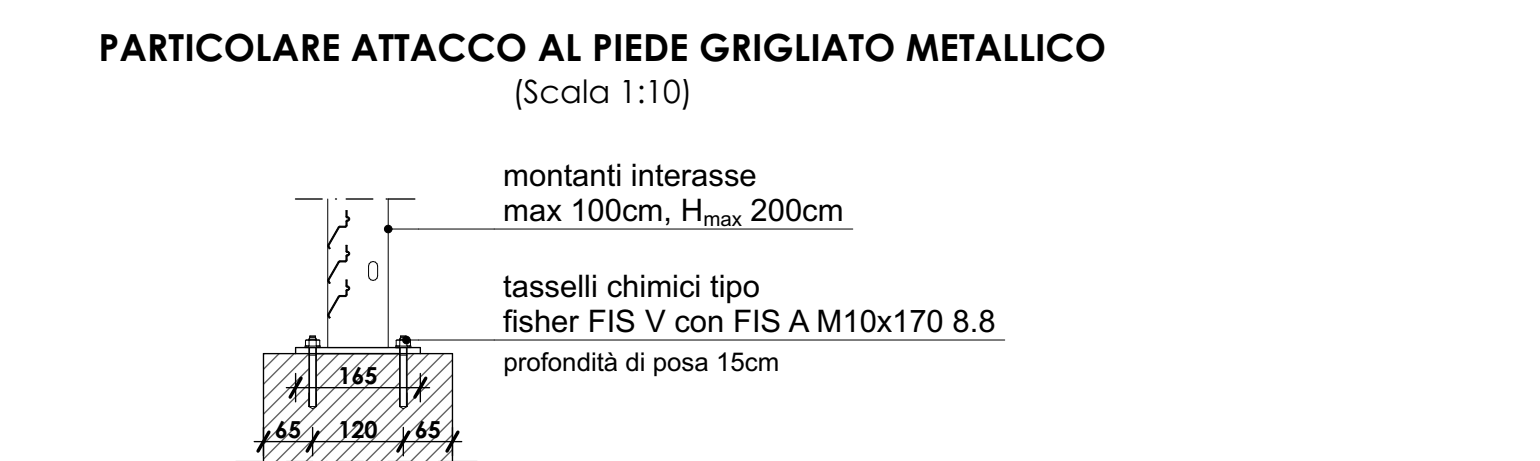
PARTICOLARE ATTACCO AL PIEDE GRIGLIATO METALLICO (Scala 1:10)
